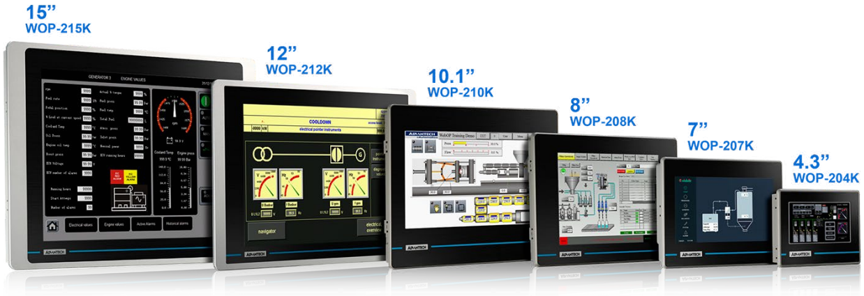
Slika 4: WOP-200K z LCD zasloni različnih velikosti (od 4,3" do 15").
